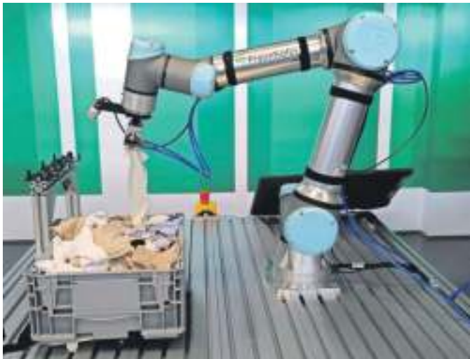
Im Projekt „Pick4Crcl“ entsteht ein Demonstrator für das roboterbasierte Erkennen und Sortieren von Textilien.
